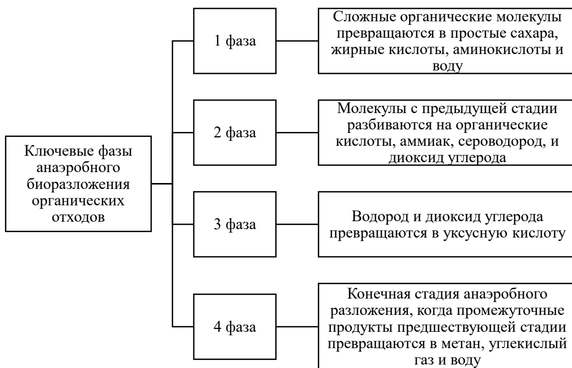
Рисунок 1 – Ключевые фазы процесса анаэробного разложения органических отходов [12]
